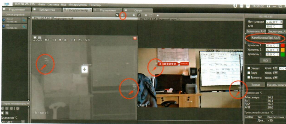
Рисунок 7. Совмещение полей обзора инфракрасной камеры и камеры видимого диапазона
