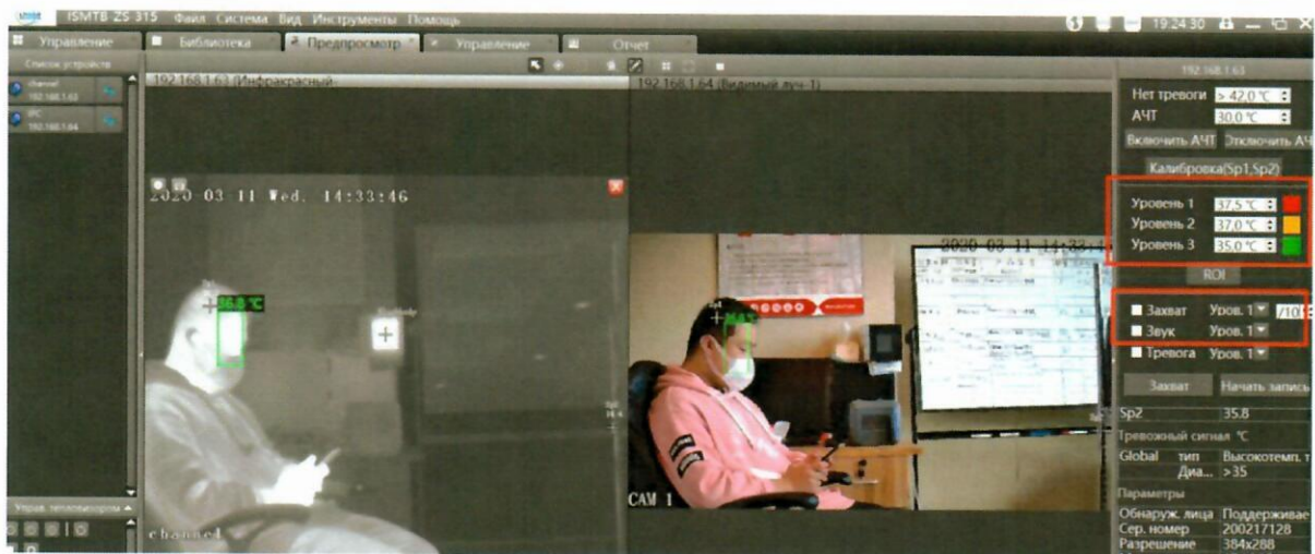
Рисунок 10. Настройка срабатывания сигнализации (захват изображения и звуковой сигнал)
