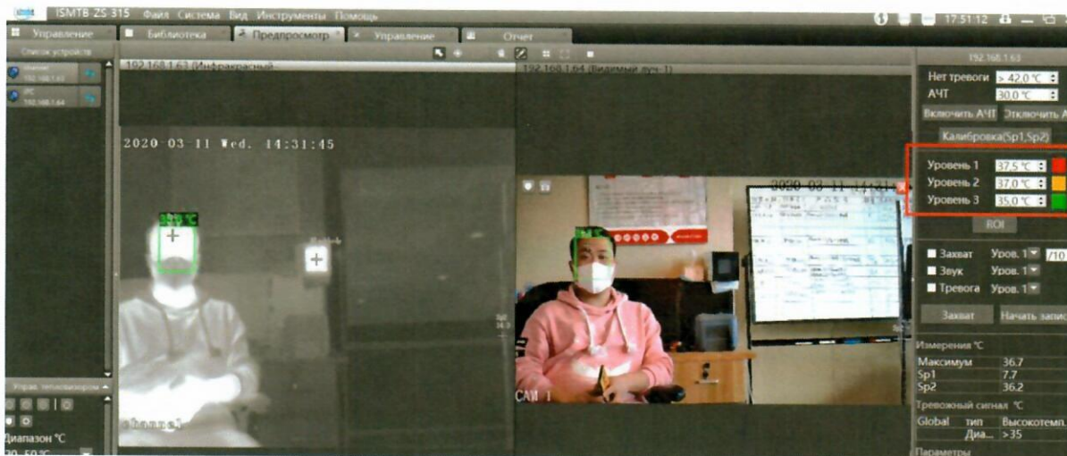
Рисунок 9. Настройка пороговых уровней срабатывания
