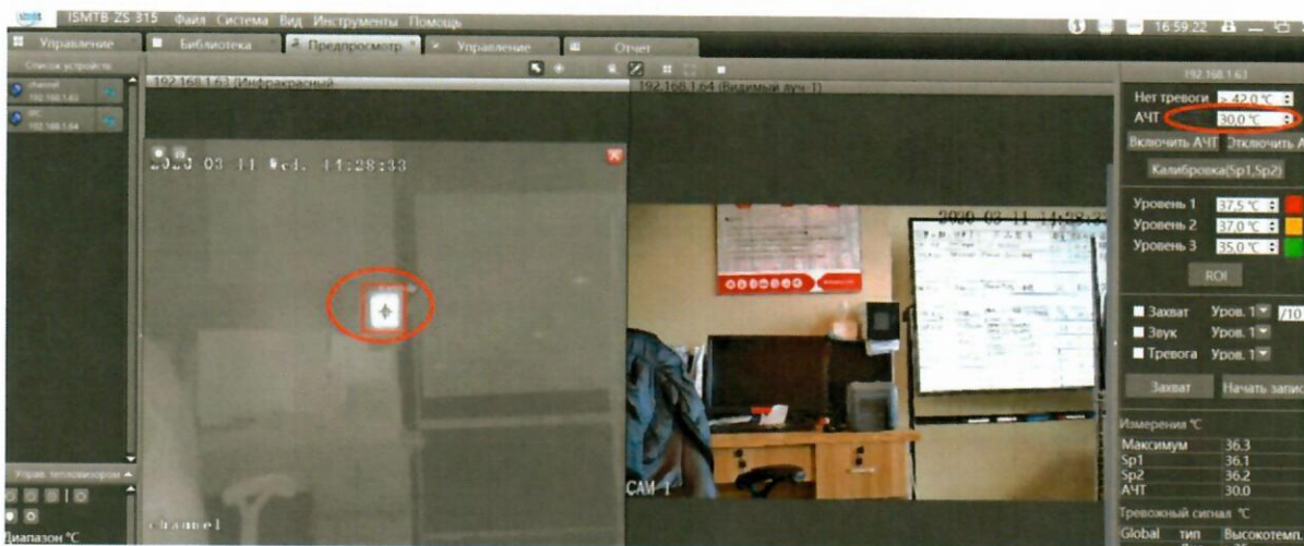
Рисунок 6. Настройка опорной точки АЧТ
