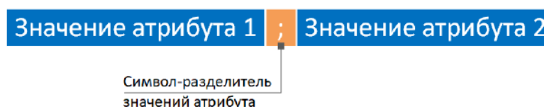
Рисунок 4.2.12 – Схема формирования перечислений в значениях атрибутов элементов
