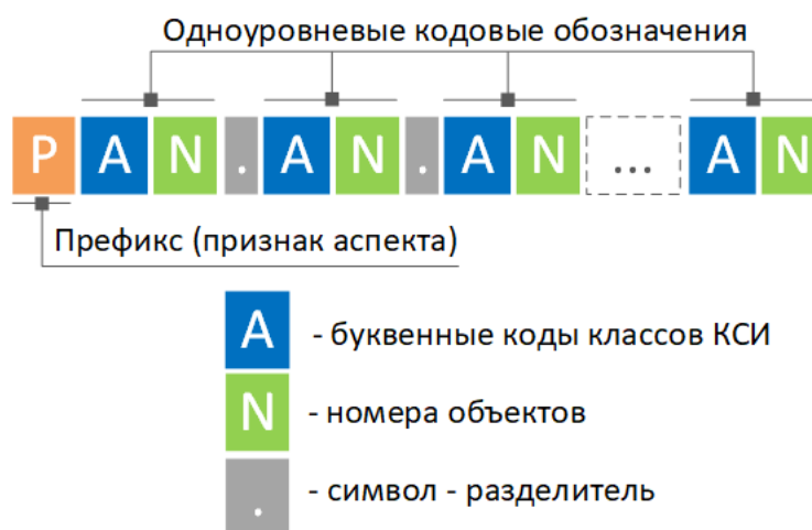
Рисунок 6.3.1 – Схема формирования многоуровневого кодового обозначения для объекта в рамках системы
