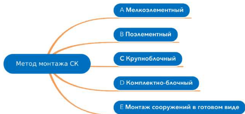
Рисунок 6.6.2 – Классы методов монтажа СК для пользовательского аспекта «Метод монтажа по степени укрупнения конструкции»
