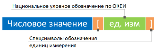
Рисунок 4.2.11 – Схема формирования значений для количественных атрибутов с единицами измерения
